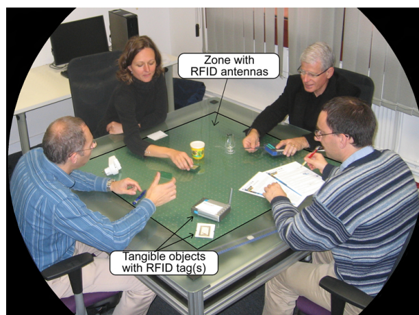
Figure 1 : Prototype v1 de la table interactive utilisé dans un contexte de travail collaboratif avec des objets tangibles
